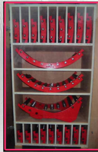
製管ケージ (組立て前の状況)
